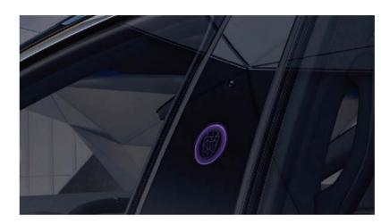
福耀玻璃开发智能立柱,集成各大模块,把人机交互结果直接显示在立柱上,在智能驾驶模式下监控周边环境,在静态模式下启动安全监控,保障车辆处于实时监控警戒状态。同时,智能立柱还实现了无钥匙进入、指纹识别、车辆定位等功能,极大的提升了驾驶体验感。
